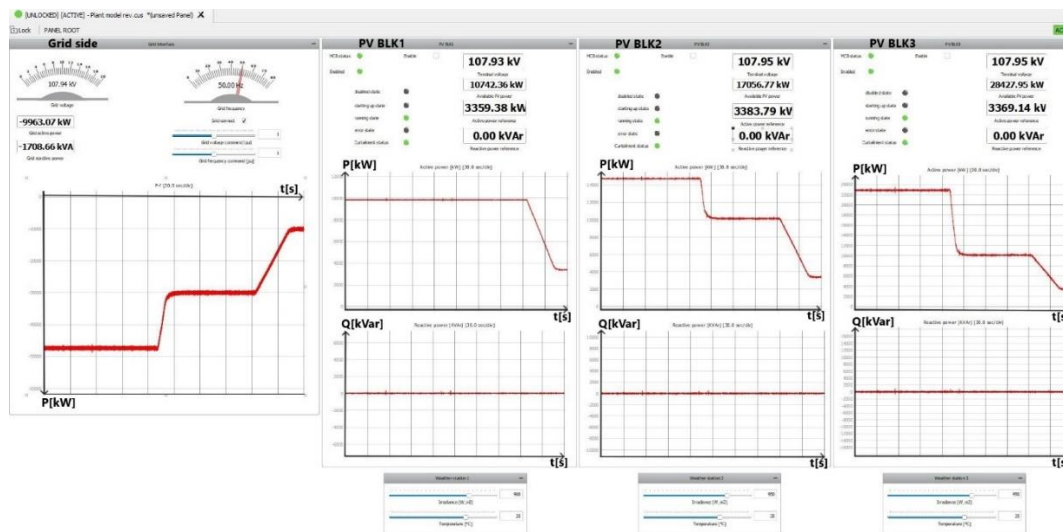
Slika 11: Prikazi u kontrolnom panelu HIL-a nakon procesuiranja druge postavne vrednosti
