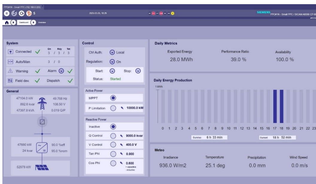
Slika 6: Sekvenca startovanja elektrane i postizanja nominalne snage
